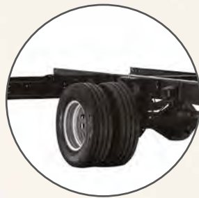
Bakhjulsdrivning med tvillingdäck och luftfjädring av drivaxeln
