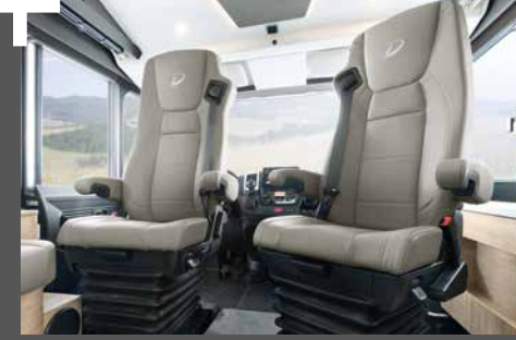
Ännu mer resekomfort: SKA-stolar med luftfjädring inkl. sättsvärme och sättsventilation (tilläggsutrustning i integrerade modeller)
