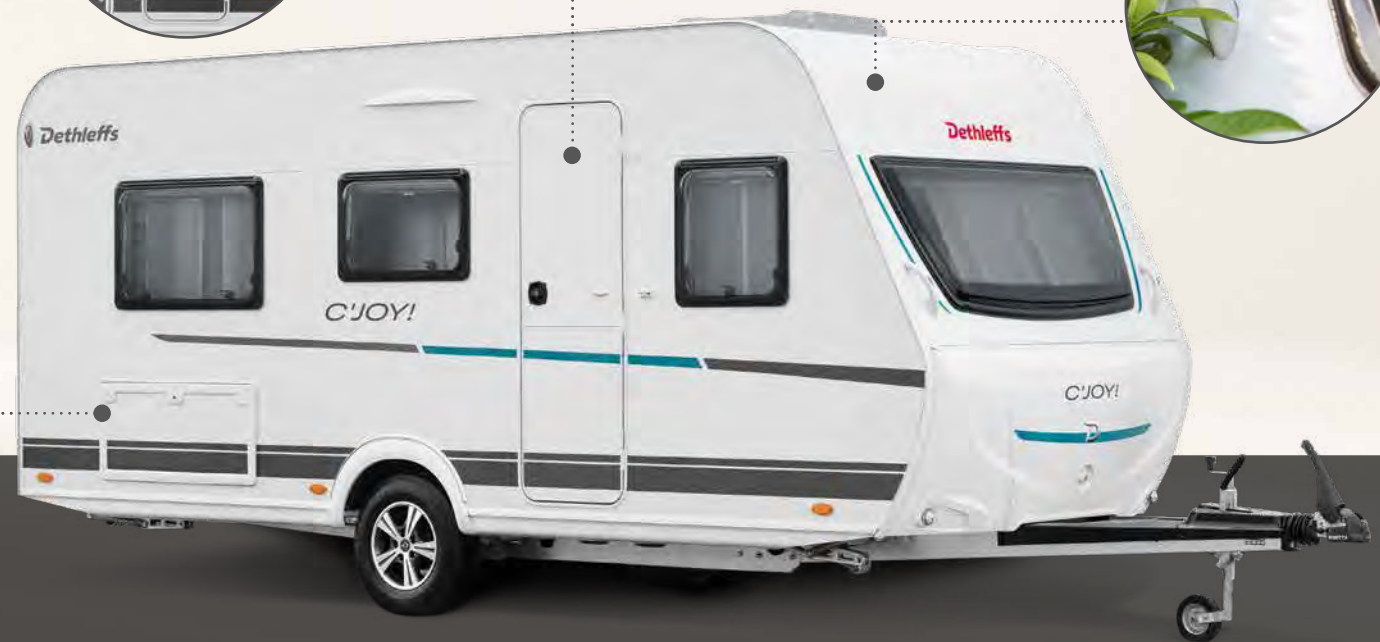
Front, tak och bakparti av motståndskraftig, glas- fiberförstärkt plast
