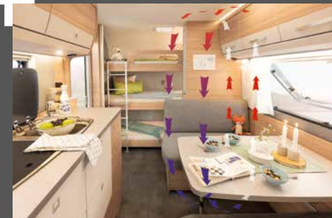
AirPlus – perfekt luftcirkulation inne i fordonet och bakventilerade överskåp och inredningsdetaljer
