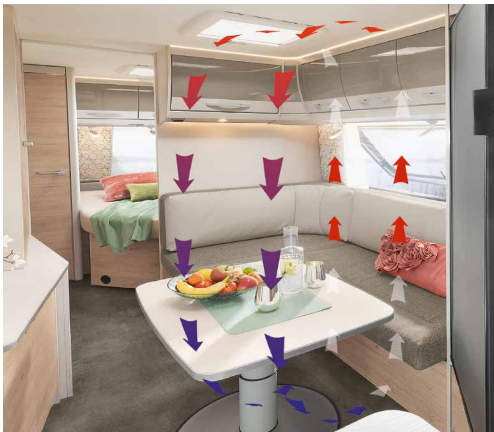
AirPlus ventilerar bakom överskåpen och förhindrar därmed bildning av kondensvatten
