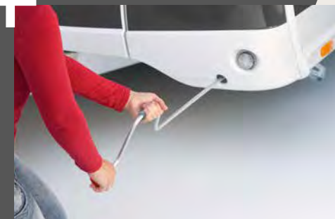
Vev-införingshjälp för enkel hantering av stödbenen
