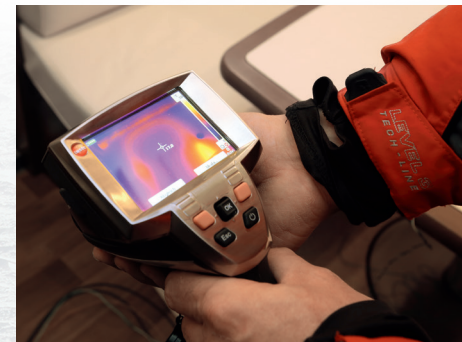
Temperaturen testas med en värmkamera
